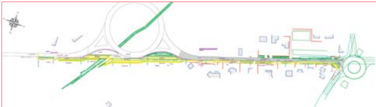
Progetto della pista ciclabile tra Via De Amicis e la rotatoria in Borgo Padova.
